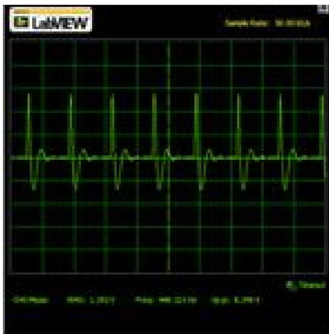
*Figura 9.1b . Aspecto de una onda tipo impulso en un osciloscopio.*
