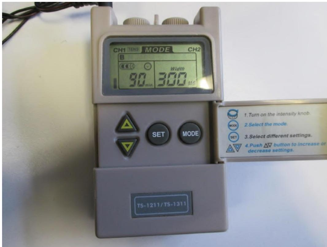
*Figura 9.4. Vista frontal de un TEN mostrando el Modo en el estado “B”; pulsando el botón MODE se puede cambiar éste.*
