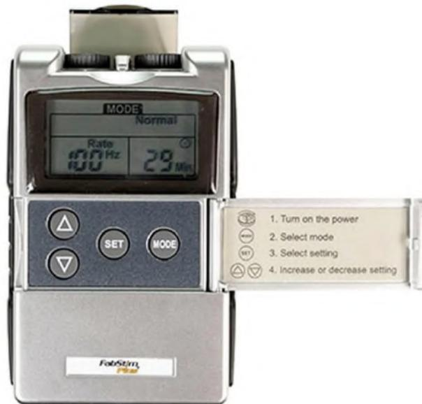
**Figura A.1. Aspecto de un TENS, se muestra el apuntador en el Modo Normal "N", el cuadro de ajuste del tiempo total de tratamiento, el de amplitud del pulso, así como los botones de flechas hacia arriba, abajo y los botones de SET y MODE; así como distintas marcas de TENS.**
